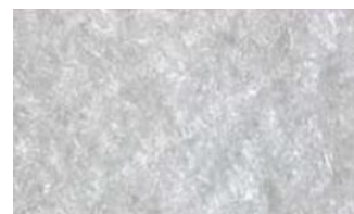
PP聚丙烯/PE聚酯针刺毡滤材（代号PP、PE）
